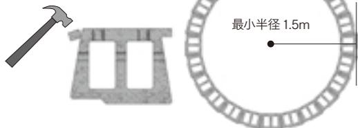
(注) ストーンセレクト基本型のウイングをハンマーで割り落とすことで、最小半径約1.5mの曲線施工が可能です。
