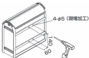
②アダプタに同梱しているねじを使って、取出口蓋を開けて、ポスト内側から、取付けてください。
