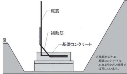
基礎型枠を組み、構造設計に従った配筋を行った後、基礎コンクリートを打設してください。
