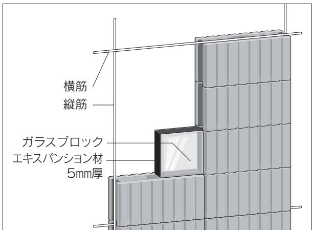
②納まりの出入りでは、コンクリートブロックの断面のセンター位置とガラスブロックの断面のセンター位置を合わせてください。
