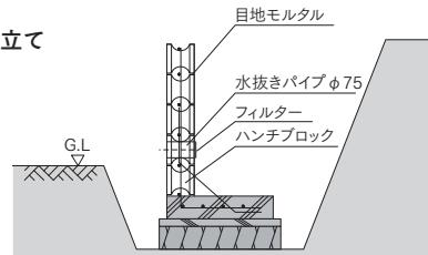
目地をモルタル施工しながら、所定の高さまで組積行ってください。その際、内部にはみ出たモルタルは、かき落してください。その後、排水用の水抜きパイプを挿しフィルターを設けてください。
