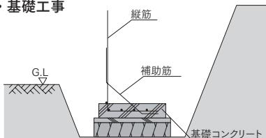
基礎型枠を組み、適切な配筋工事を行った後、基礎コンクリートを打設します。
