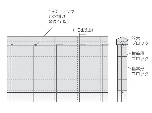
図6 笠木ブロックの施工例
