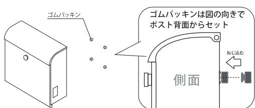
3. 門柱付属のトラス小ネジでポストをしっかりと固定してください。
