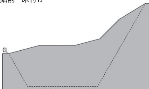
地耐力を確認し、設計図書を基に掘削した後、床付けを行ってください。機械掘りの後は表面が荒くなってしまい耐力に影響があるため、手作業による仕上げで平にしてください。
