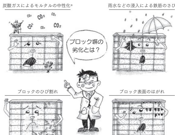
\*中性化とは、モルタルと炭酸ガスとの反応により、モルタル中のアルカリ性が低下し、鉄筋の保護機能が失われる現象。
