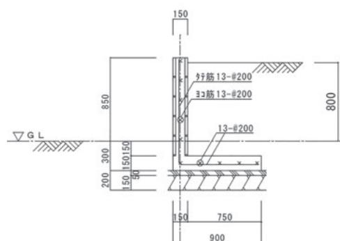
擁壁 : H = 0.80m 地耐力 : 45kN/m<sup>2</sup>
