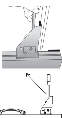
②平ワッシャー → ばねワッシャー → 袋ナットの順でボルトに通し、手で軽く締めてください。(まだゆるんだ状態)
