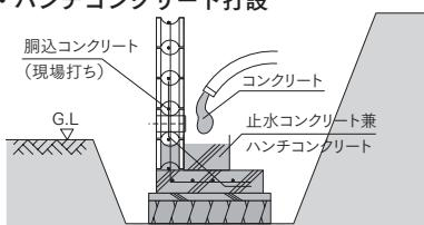
止水兼ハンチコンクリートの型枠を立て、中間の高さくらいまでコンクリートを打設し、バイブレーターと突き棒にて確実に充填してください。
