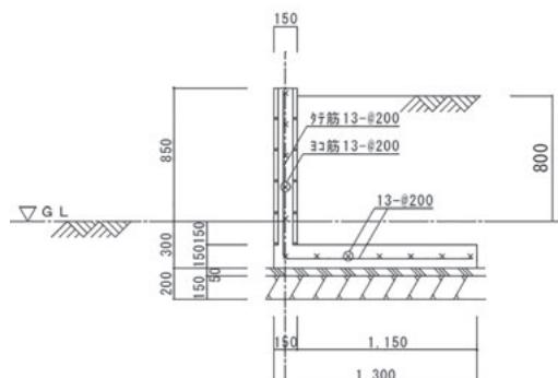
擁壁 : H = 0.80m 地耐力 : 35kN/m<sup>2</sup>
