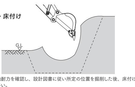
掘削場所の地耐力を確認し、設計図書に従い所定の位置を掘削した後、床付けを行ってください。
