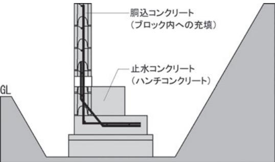
前壁にコンクリートを打設し、バイブルーターや突き棒で確実に充填してください。
