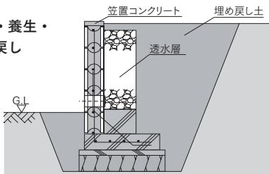
笠置コンクリートを打設してください。その後、コンクリートの養生を行い、透水層を設置しながら埋め戻しを行ってください。
