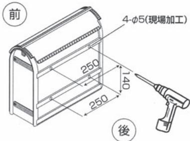
②同梱のプラグボルトと木ねじを使って、取出口蓋をあけて、ポスト内側から、下記の手順で壁面に取付けてください。
