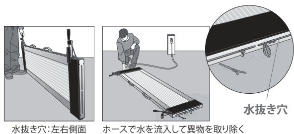
水抜き穴:左右側面 ホースで水を流入して異物を取り除く
