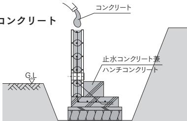
脳込コンクリートを打設し、バイブレーターと突き棒にて確実に充填してください。その際、止水兼ハンチコンクリートが設計高さまで湧き上がるのを確認してください。
