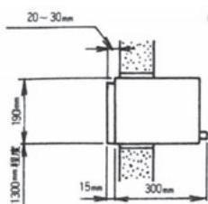
ポストより縦・横20mmぐらい大きめの穴を壁にあけポストを入れます。(500mmブロックタイプのSP型幅490mm×高さ190mm、400mmブロックタイプのSS型幅390mm×高さ190mm)
