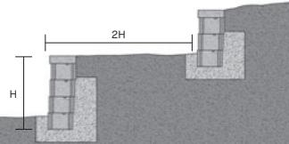
※2段目の擁壁は、1段目の高さ以下にしてください。
