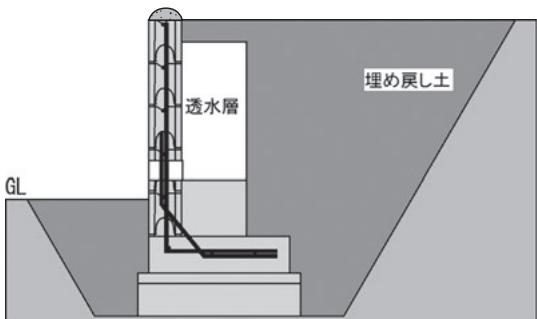
十分な養生後、止水コンクリートの上に砂利や碎石を用いて透水層を設置しながら埋戻しを行ってください。透水層は幅30cmで、高さは擁壁天端より10cm程度下がったところまでとします。
