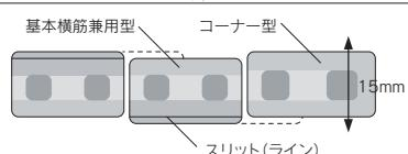
コーナーおよび1/2コーナー型は他の形状に比べ、空洞部が大きくなっています。施工全体のバランスを考えて前後15mm程度の調整が可能です。また、隣合う基本横筋兼用型のスリット(ライン)を利用し調整をしてください。
