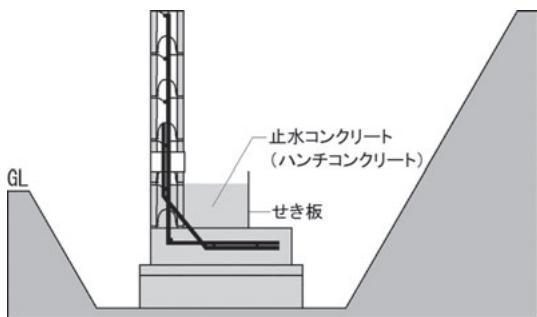
幅30cmで止水コンクリート用の型枠を立てた後、バイブレーターや突き棒で確実に充填しながらコンクリートを打設してください。高さは水抜き穴にかぶらない程度とします。
