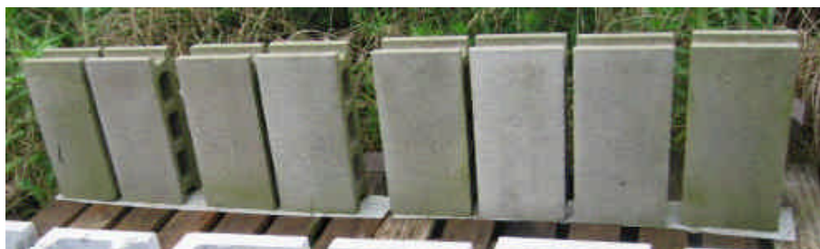
暴露試験状況(左から2つ目がSC加工)
